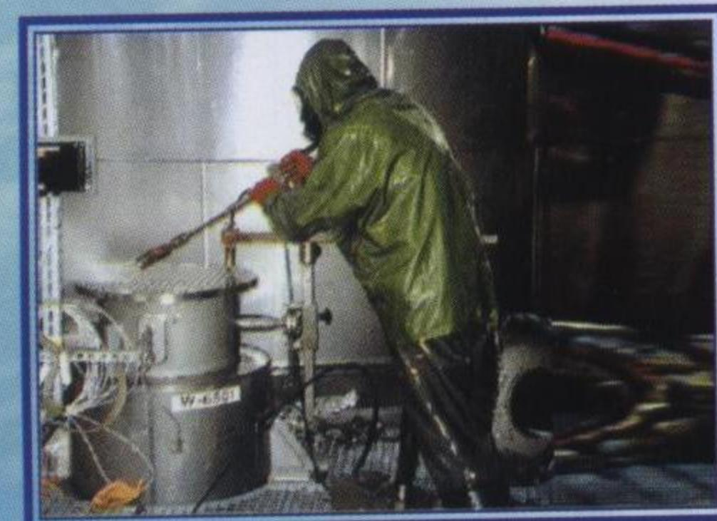
давлением подается в рабочую зону через специальные насадки. В качестве насадок используются различные модификации распределителей струи высокого давления. Вода под высоким давлением легко справляется с самыми стойкими загрязнениями и покрытиями, а используя различные насадки, воду под давлением можно подать в самые труднодоступные места.
