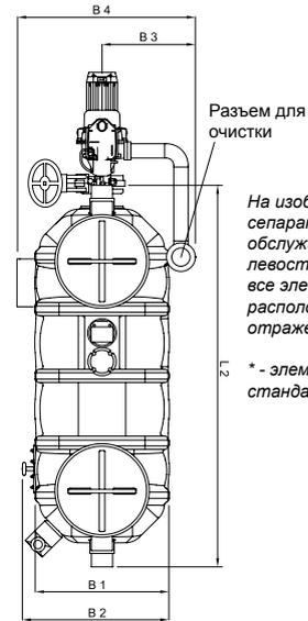
На изображении показан сепаратор номиналом 4л/с, обслуживаемый справа. При левостороннем обслуживании все элементы будут расположены в зеркальном отражении.
