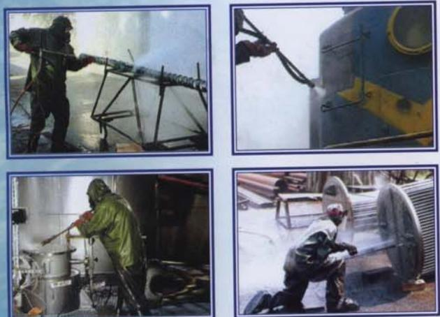
давлением подается в рабочую зону через специальные насадки. В качестве насадок используются различные модификации распределителей струи высокого давления. Вода под высоким давлением легко справляется с самыми стойкими загрязнениями и покрытиями, а используя различные насадки, воду под давлением можно подать в самые труднодоступные места.
