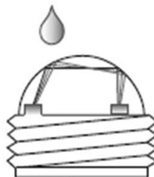
Рис. 12 Оптоэлектронный датчик обнаружения утечки
